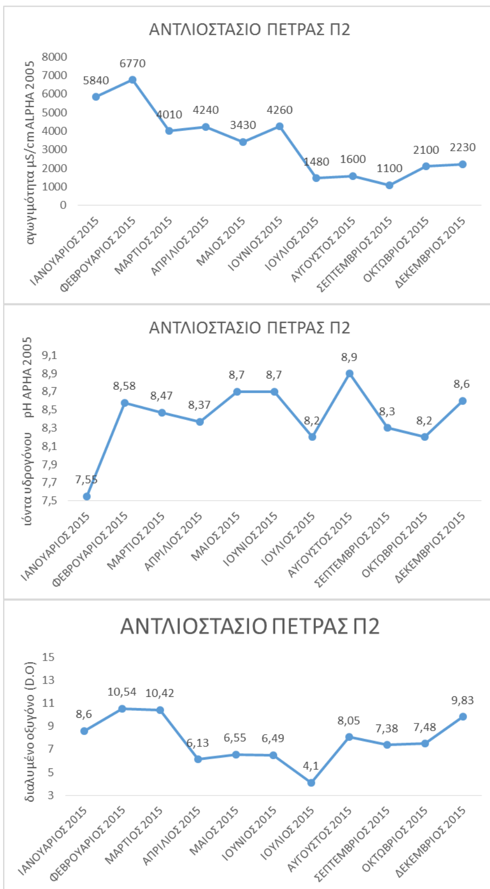
Εικόνα 3.11. Μεταβολές στην αγωγιμότητα, στο pH και το διαλυμένο οξυγόνο για το έτος 2015 στο σταθμό δειγματοληψίας του αντλιοστασίου της Πέτρας.
